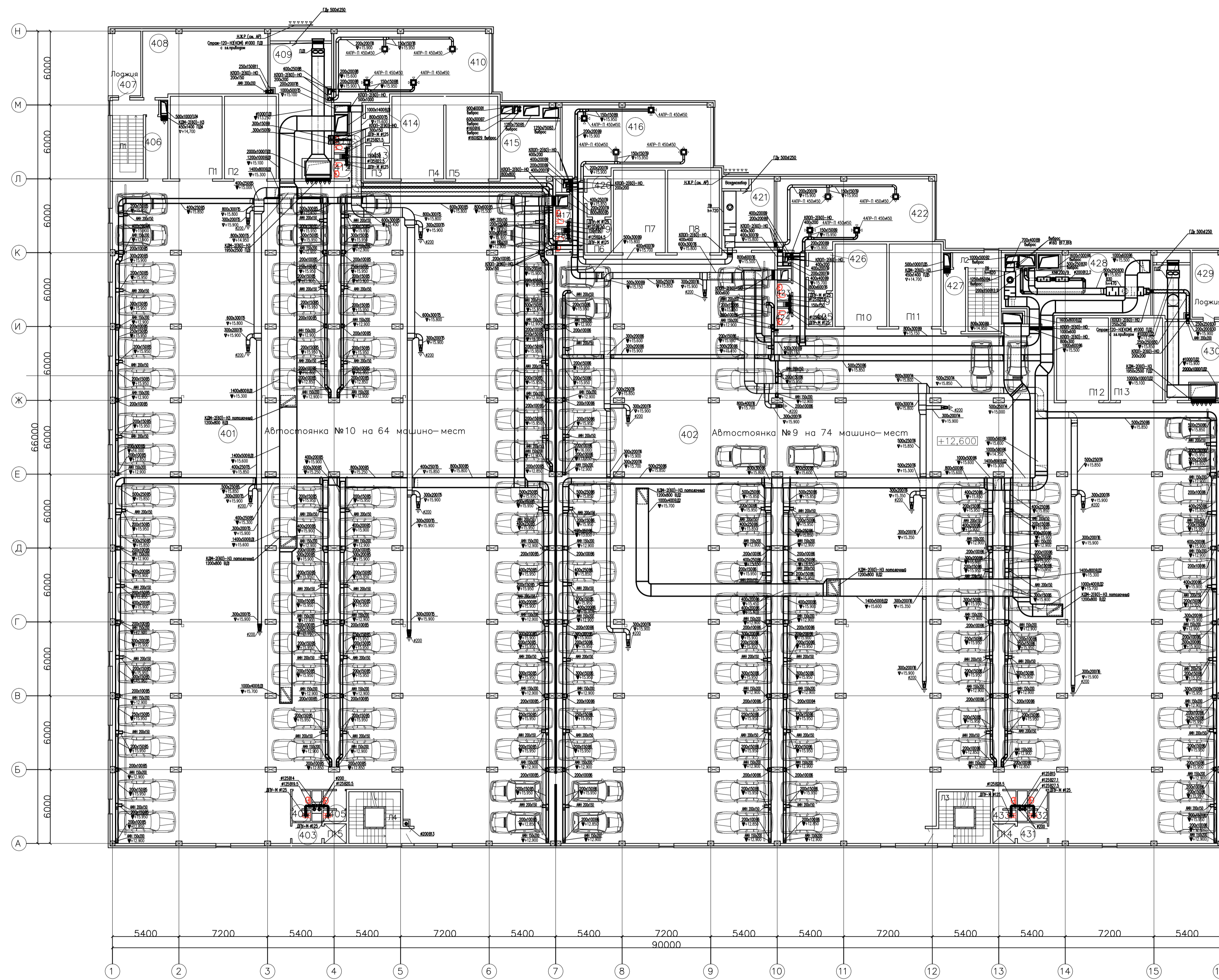
План 4-го этажа с системами вентиляции
